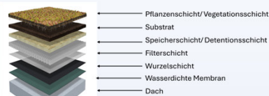
Aufbau eines Modell-Gründaches
