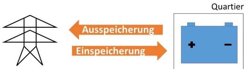
Als eine weitere Option kann ein Stromspeicher völlig losgelöst von der Photovoltaik-Anlage genutzt werden. Stattdessen wird er ausschließlich mit Strom aus dem öffentlichen Netz beladen. Dieser Strom wird zeitlich verzögert wieder ins öffentliche Netz eingespeist. Der Einstieg in den Regelenergiemarkt ist jedoch aktuell noch mit erheblichen, gesetzlichen Anforderungen verbunden ist (Sternner und Stadler 2017, S. 833f)<sup>1</sup>, da hier spezielle Gesetzesgrundlagen greifen.
